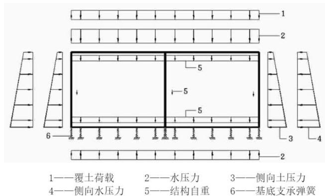
1—覆土荷载      2—水压力      3—侧向土压力
