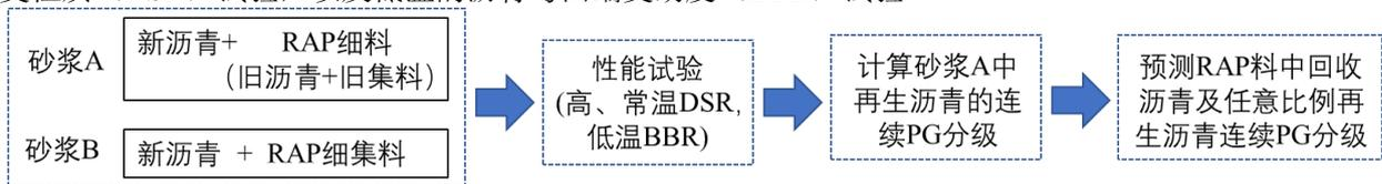
图1 砂浆测试流程图
